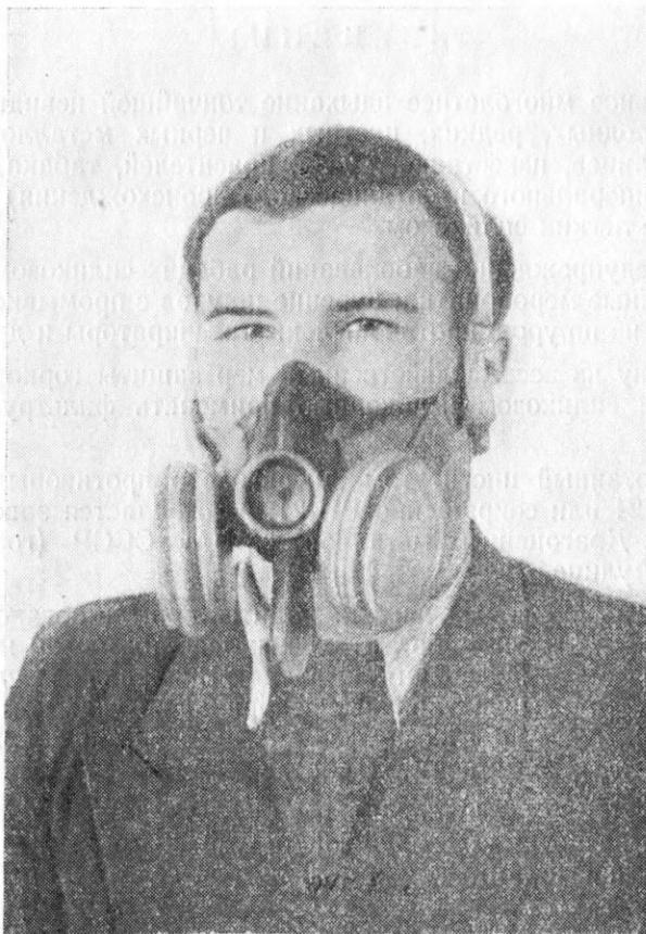
а) Лицевая часть респиратора, штампованный из резины, изготавливается трех размеров (№№ 1, 2 и 3). Номер полумаски указывается во внутренней носовой ее части.
